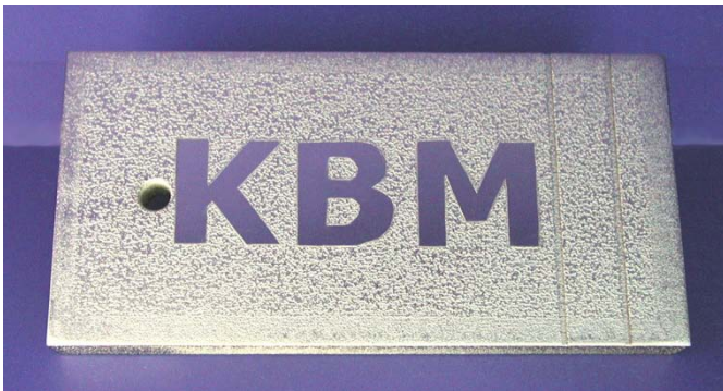
BS-ET处理后的化学镀镍外观 英文字母是未浸蚀处理的部分
